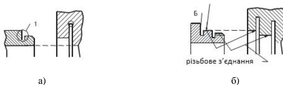
Рис. 4.1. З'єднання тубусів: а – з'єднання тубуса з корпусом на різьбленні: 1 – упорні базові поверхні, забезпечує базування по оптичній осі, не забезпечує точного центрування через зазор у різьбленні; б – з'єднання на різьбленні із центруванням по гладкій циліндричній поверхні, забезпечує гарне центрування уздовж осі й перпендикулярно осі
