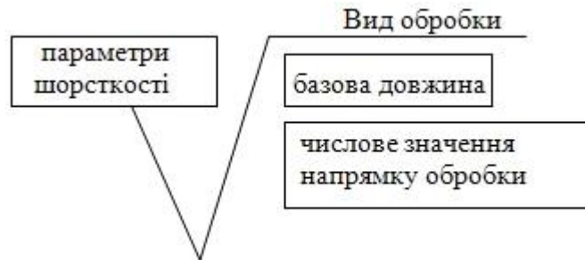
Рис. 1.25. Повне позначення шорсткості
