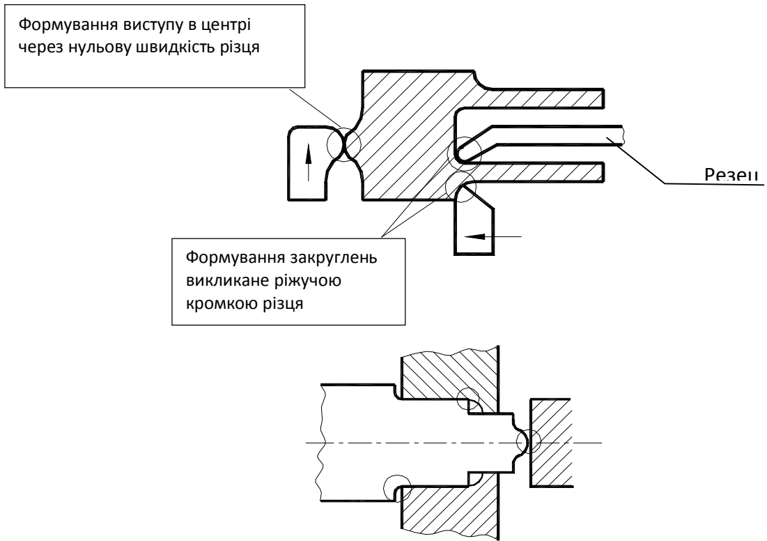
Рис. 2.7. Токарська обробка. Неможливість точного сполучення
