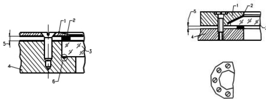
Рис. 3.32. Кріплення захисних скелець: 1 – кріпильна планка; 2 – ущільнення; 3 – захисне скло; 4 – корпус; 5 – гарантований зазор; 6 – кільцева проточка для розміщення надлишків ущільнення
