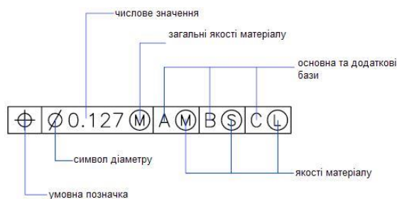
Рис. 4.34. Формат елемента допуску поверхні
