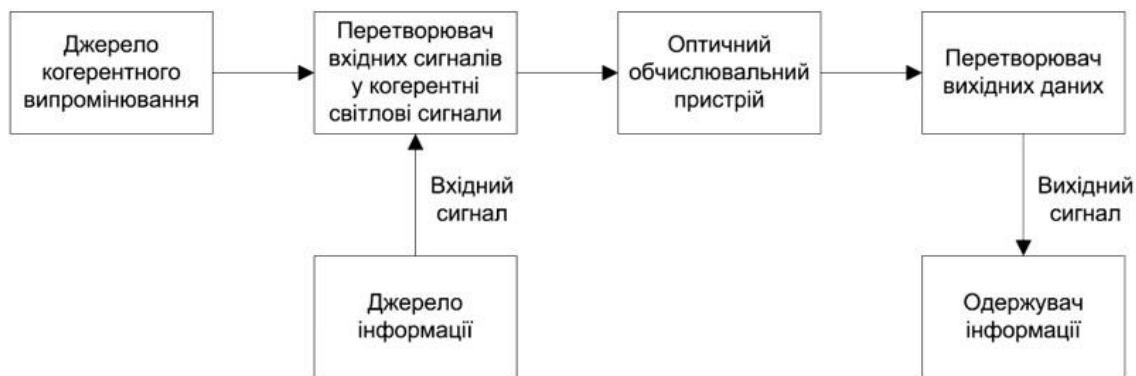
Рисунок 1.1. Блок-схема оптичної обробки інформації
