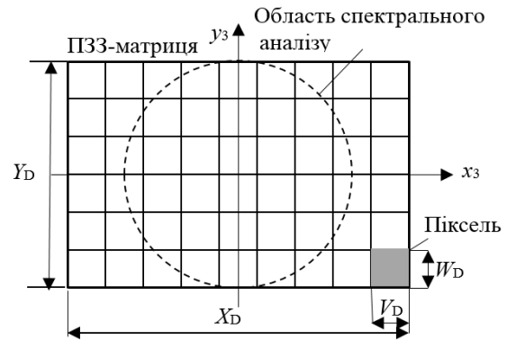
Рисунок 5 – Площина спектрального аналізу когерентного спектроаналізатора
