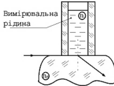
Рис. 3.36 Рефрактометр Пульфріха – вимірювання показника заломлення рідини
