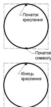
Рис. 4.11. Схема малювання вертикальних символів
