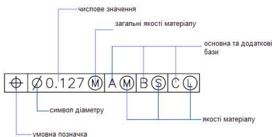
Рис. 4.39. Формат елемента допуску поверхні
