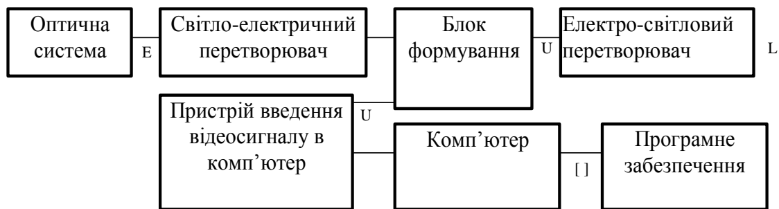
Рис.1. Узагальнена структура телевізійного засобу вимірювання
